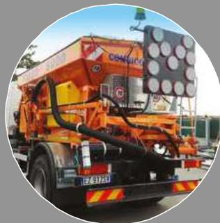
Mezzo speciale dotato di freccia luminosa per cantiere mobile
